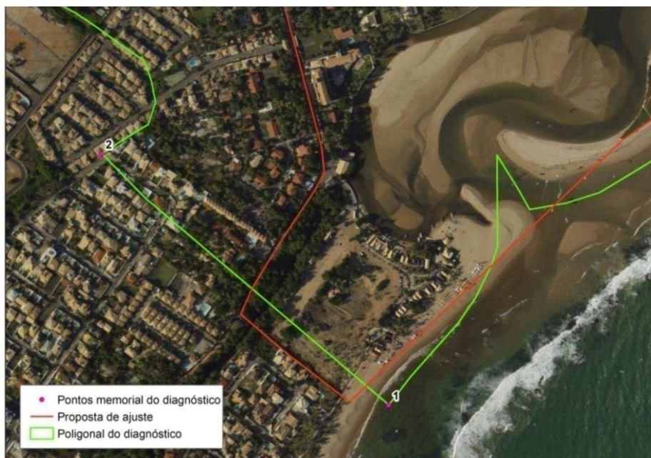
Figura 8 - Inconsistência no Posicionamento e Incoerência no Traçado. Fonte: INEMA, 2018.
