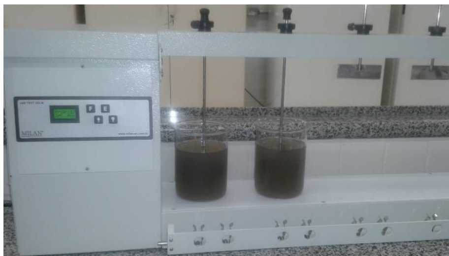
Figura 7 – Equipamento de Jar test utilizado no processo de clarificação química.
