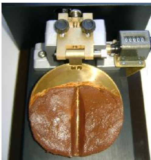
Figura 8 – Aparelho Casagrande elétrico com amostra de solo seccionada por meio da utilização do bisel. UTFPR, Pato Branco - PR, 2016.
