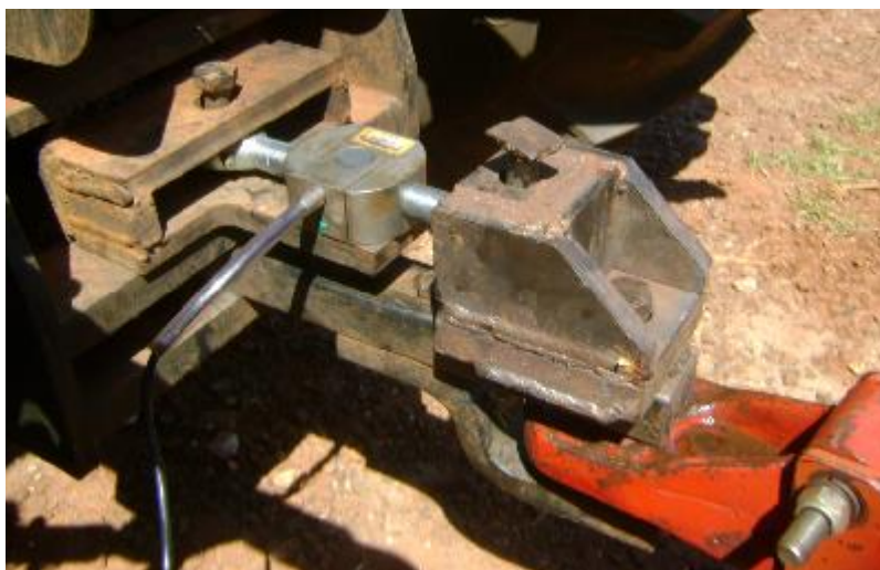
Figura 12 – Célula de carga instalada entre a barra de tração móvel do trator e o cabeçalho da semeadora-adubadora. UTFPR, Pato Branco - PR, 2016.
