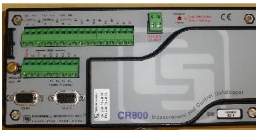
Figura 11 – Datalogger para armazenamento dos dados produzidos pela célula de carga. UTFPR, Pato Branco - PR, 2016.
