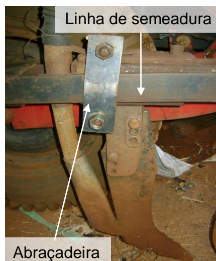
Figura 10 – Travamento do ponto de articulação da linha de plantio da semeadora-adubadora, com abraçadeira metálica. UTFPR, Pato Branco - PR, 2016.
