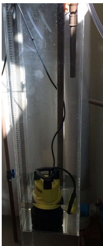
Figura 6 - Fotografia e esquema do tanque vertical (TV) sendo (1) Reservatório, (2)Bomba, (3)Registro gaveta, (4) Rotâmetro de água (5),Manômetro, (6)Vacuômetro, (7)Rotâmetro de ar, (8)Venturi, (9) Saída do jato de água, (10) Eletrodo para medição de Oxigênio, (11) Oxímetro, (12) Computador;
