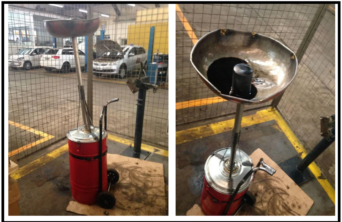
Figura 7 - Coletor de Óleo Utilizado para Realizar as Trocas de Óleos Automotivas. Fonte: A Autora (2015)
