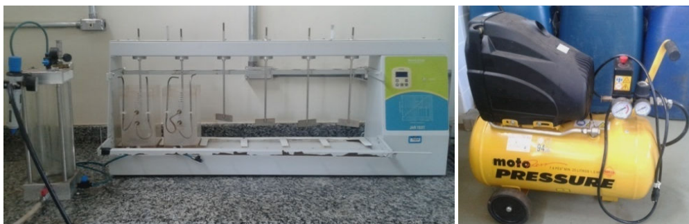
Figura 3. Equipamento Jar Test e compressor de ar empregado nos ensaios de tratabilidade
