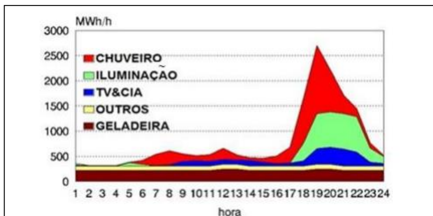
Figura 04. Impactos de aparelhos eletrodomésticos na demanda de energia. Fonte: CEMIG – Companhia Energética de Minas Gerais (2012).
