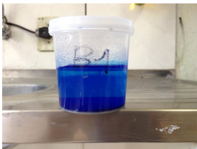
Figura 6: Amostra tratada com 20 g/l de carvão ativado
