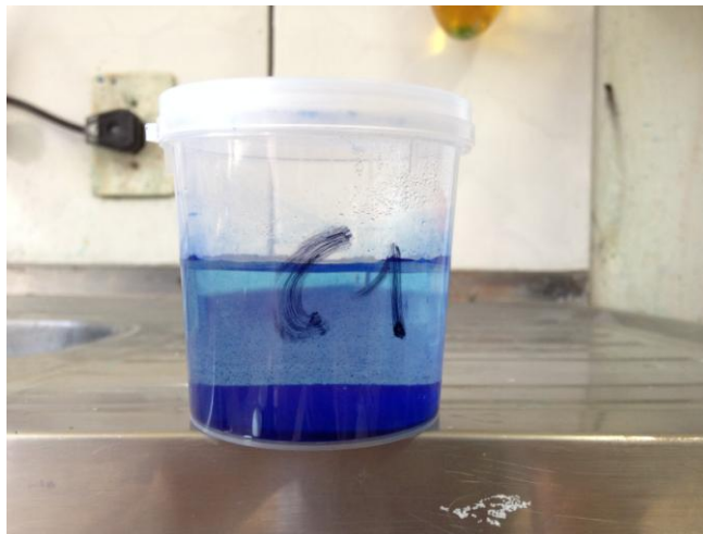
Figura 7: Amostra tratada com 30 g/l de carvão ativado
