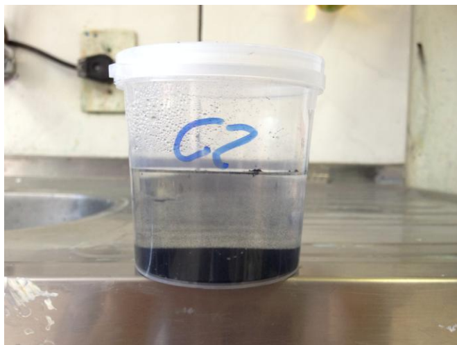
Figura 11: Tratamento com 30 g/l de carvão ativado em pó
