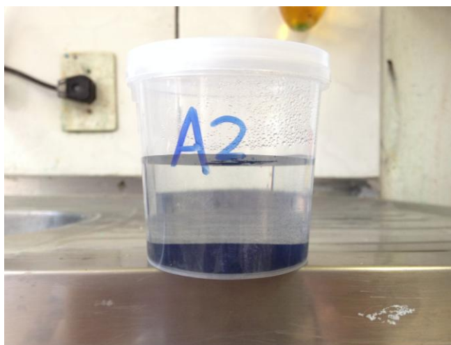
Figura 9: Tratamento com 10 g/l de carvão ativado em pó
