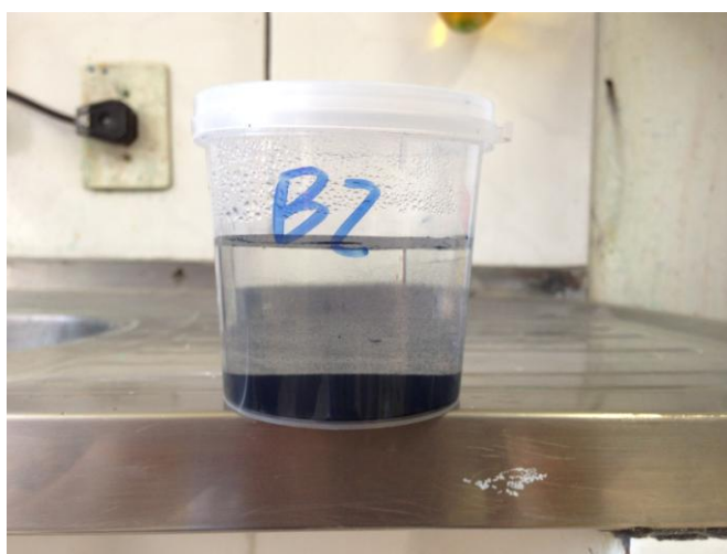
Figura10: Tratamento com 20 g/l de carvão ativado em pó
