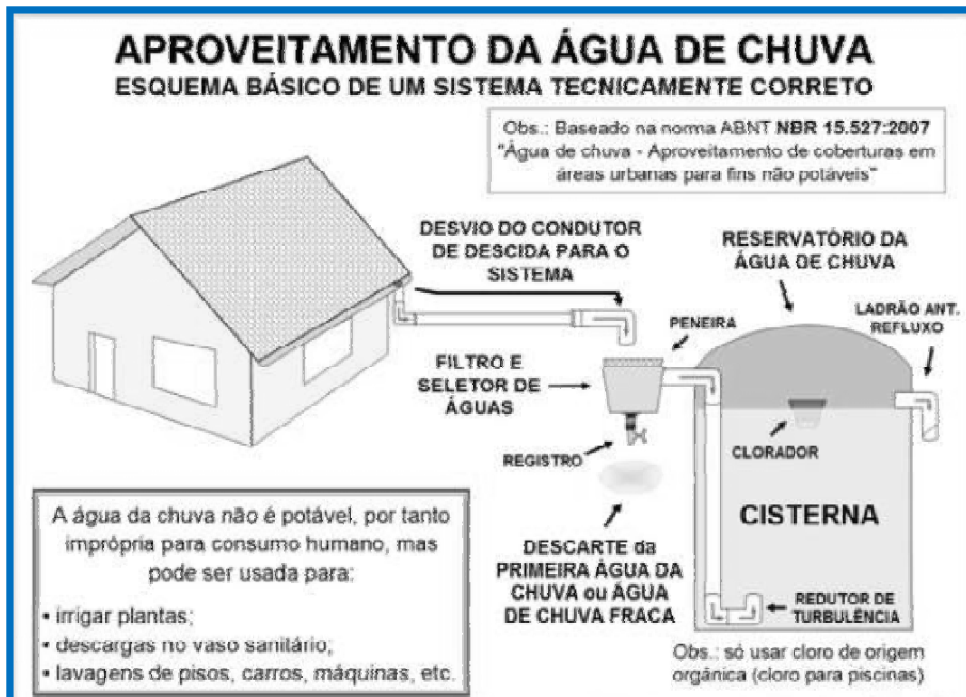
Figura 6 - Sistema de Aproveitamento da Água da Chuva em Residências. Fonte: sempresustentavel.com.br , 2015.
