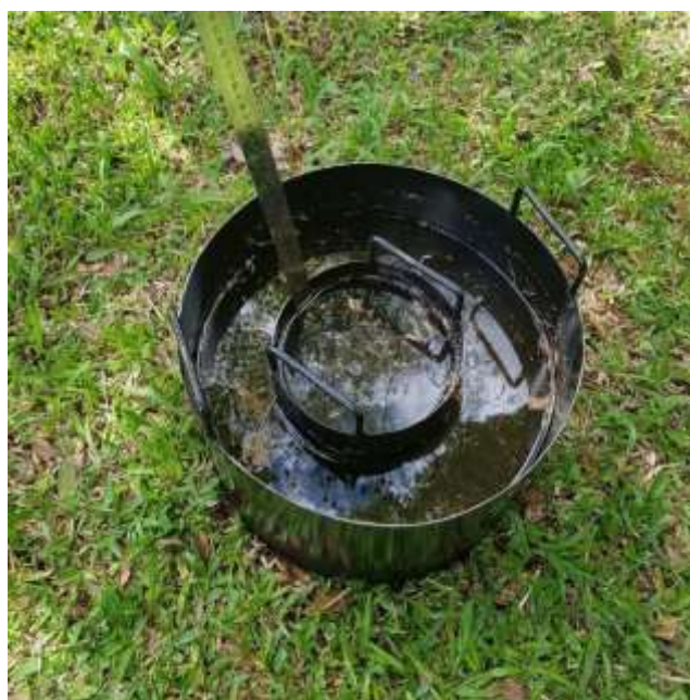
Figura 9: Teste de Infiltração em Solo Gramínea. Fonte: Autoria própria.
