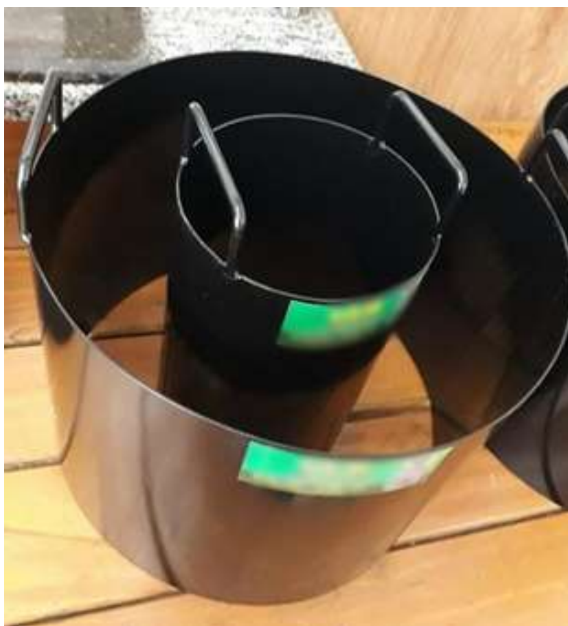
Figura 2: Infiltrômetro de Anéis Utilizado na Realização dos Testes. Fonte: Autoria própria.
