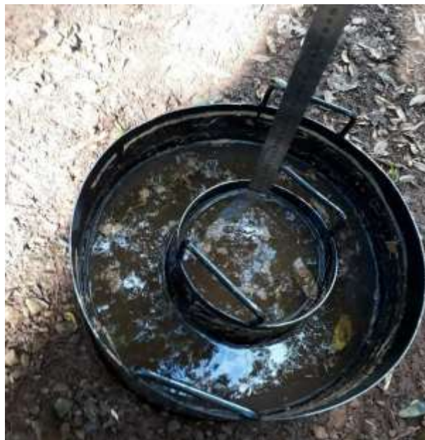
Figura 10: Teste de Infiltração em Solo Exposto. Fonte: Autoria própria.
