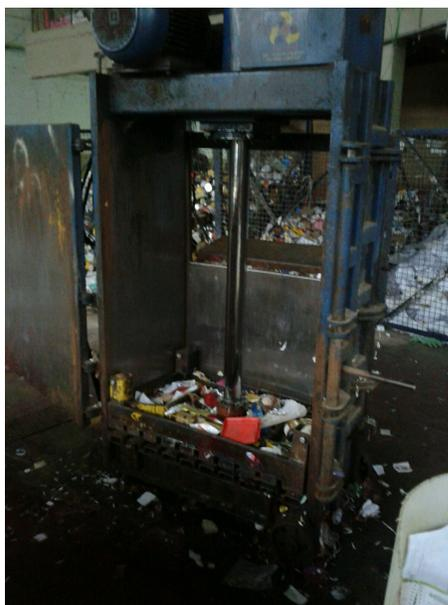
**Figura 11 – Prensa de Compactação dos Resíduos Separados.**
