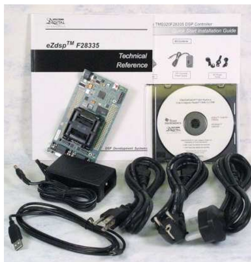
Figura 114: Kit de desenvolvimento da Spectrum Digital para o DSC TMS320F28335.
