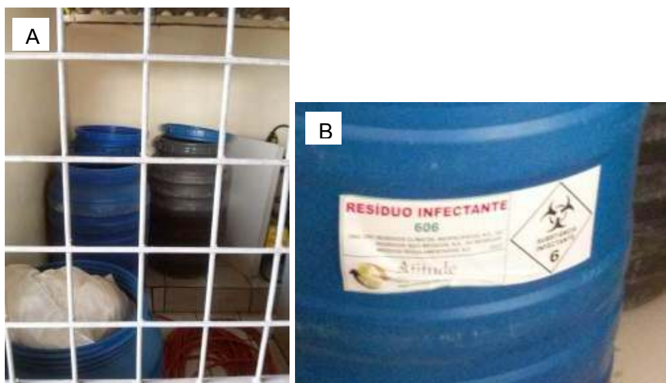
Figura 5 – A –Tambores de acondicionamento intermediário resíduo infectante; B – Identificação na lateral dos tambores de resíduo infectante.
