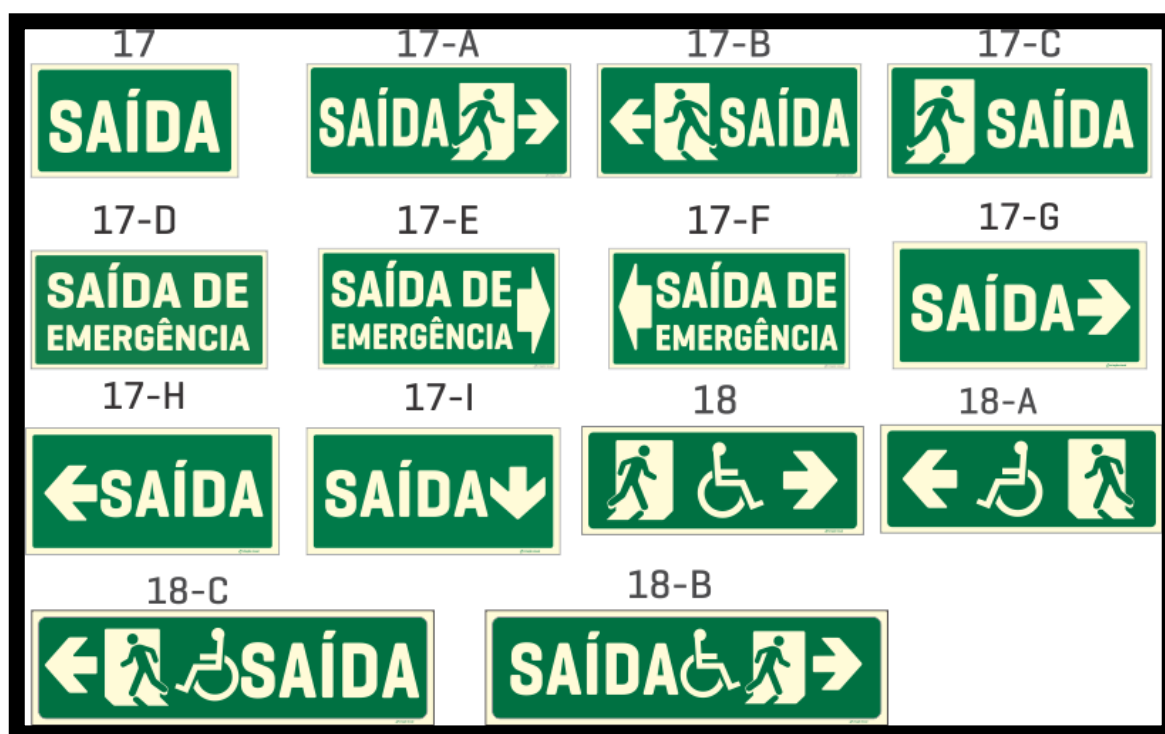
Figura 01 – Placas de sinalização de emergência conforme NPT20 – Corpo de Bombeiros.
