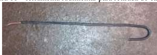
Figura 01 – ferramenta rudimentar para retirada do cavaco.
