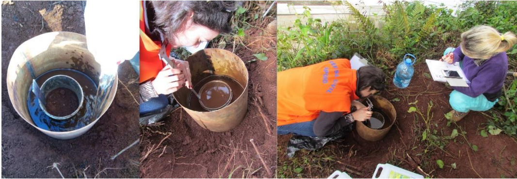
Fotografia 2: Execução do Ensaio de Infiltração.
