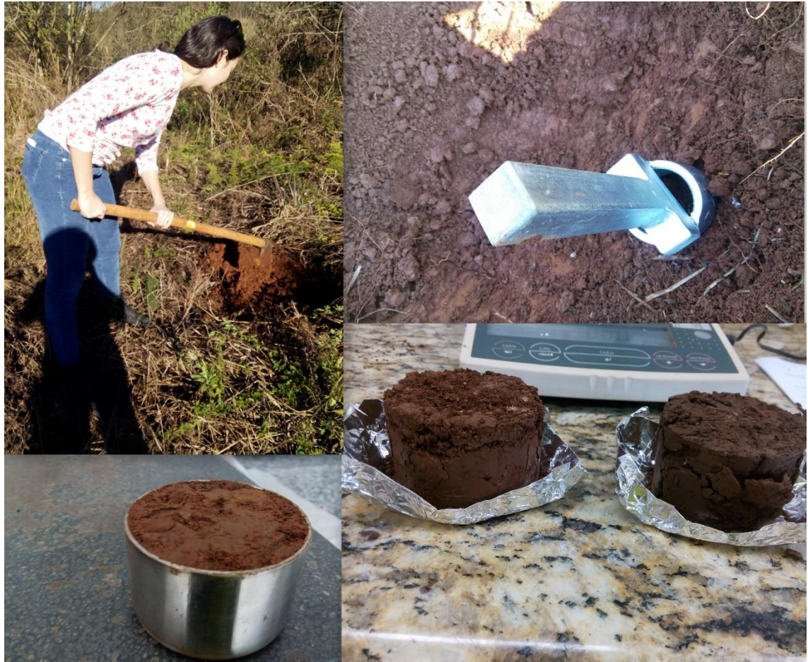
Fotografia 5: Coleta Amostras Indeformadas
