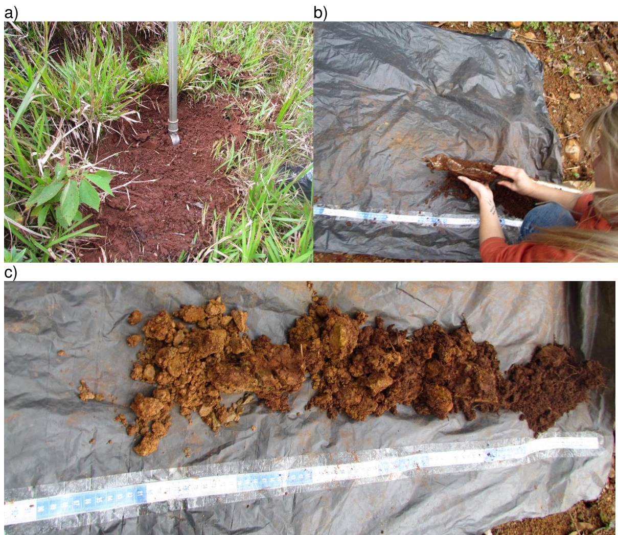
Figura 32 - Coleta de amostra de solo: a) limpeza superficial; b) trado holandês; c) traçado do perfil do solo.
