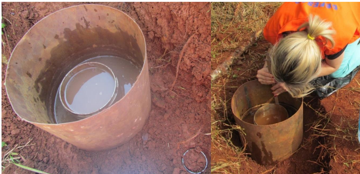
Figura 36 - Ensaio de infiltração de água no solo.
