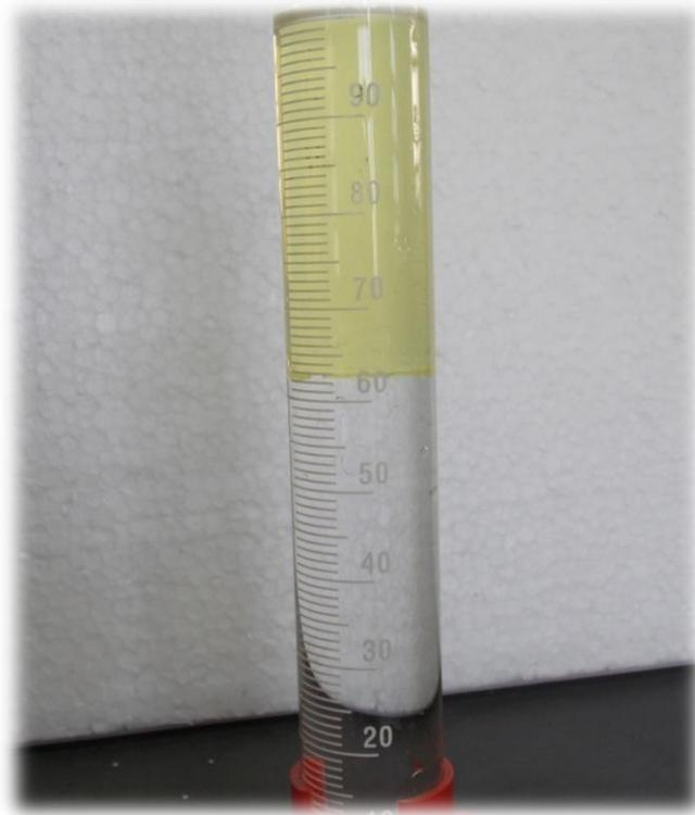
**Figura 9: Medindo a quantidade de álcool na gasolina**
