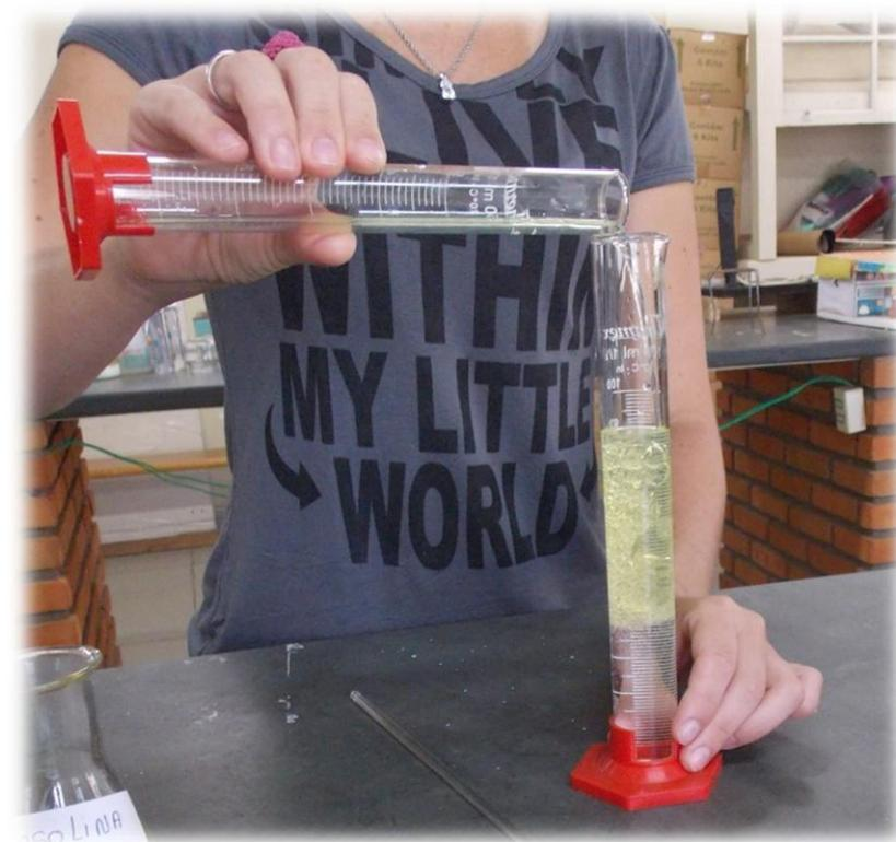
**Figura 8: Misturando gasolina com água**
