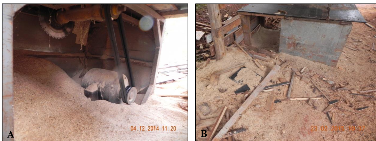
Figura 32 - Não conformidades encontradas na utilização da serra circular. A) Motor da serra circular e piso com excesso de serragem, sem caixa coletora; B) Restos de madeira e serragem sobre o piso do setor da carpintaria. Fonte: a autora (2016)
