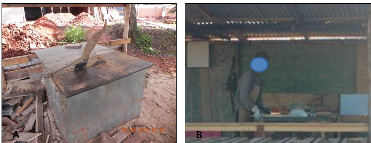
Figura 31 - Utilização da serra circular no setor de carpintaria. A) Vista lateral da serra circular; B) Bancada de trabalho com serra circular de diâmetro adequado para peças de madeira maiores, com trabalhador efetuando a atividade.
