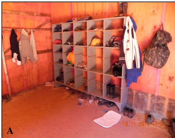
Figura 13 - Não conformidades encontradas no vestiário. A) Armários não são dotados de fechadura; B) Pisos em concreto do vestiário executado nove meses após o início da obra. Fonte: a autora (2016).
