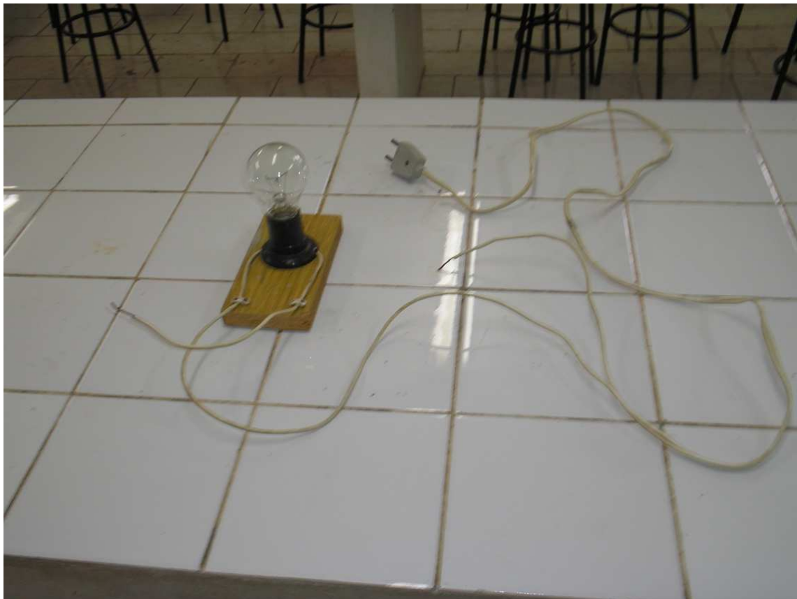
ANEXO B – Foto do aparelho usado para testar a Condutividade elétrica das soluções aquosas
