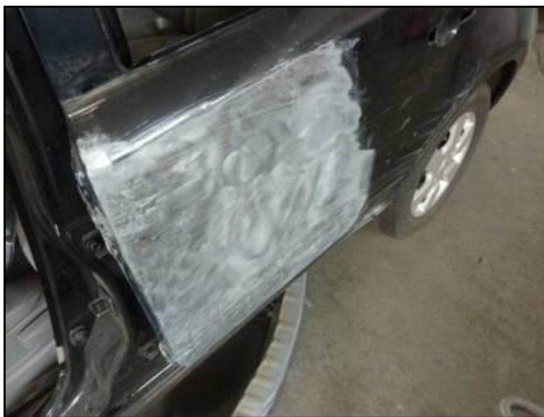
Figura 2: Processo de funilaria ou lanternagem da lata.
