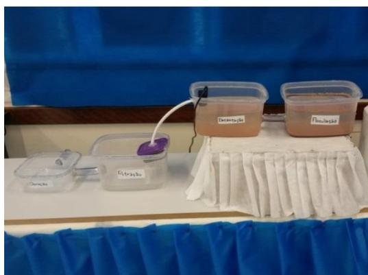
Figura 2 – Estação de tratamento de água
