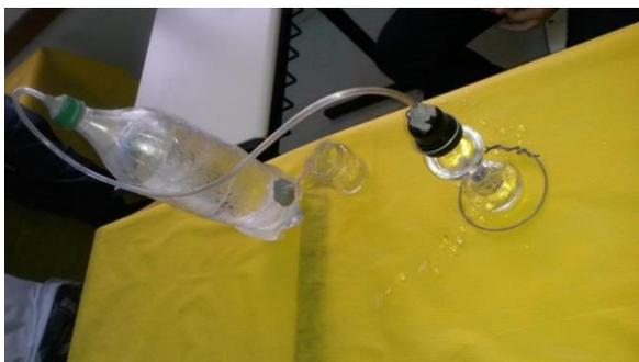
Figura 1 – Destilador: Dessalinização da água do mar
