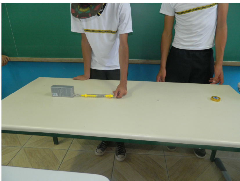
Figura 8. Medindo a intensidade da força de atrito com a caixinha apoiada na área média
