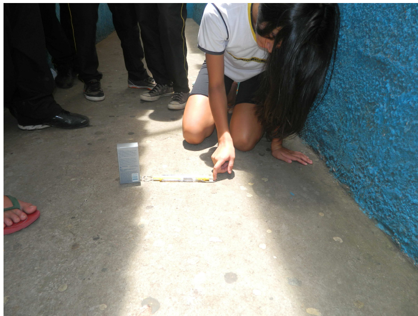
Figura 6. Medindo a intensidade da força de atrito no piso de cimento
