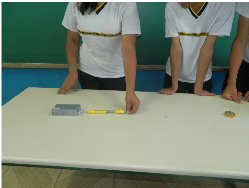
Figura 9. Medindo a intensidade da força de atrito com a caixinha apoiada na área maior
