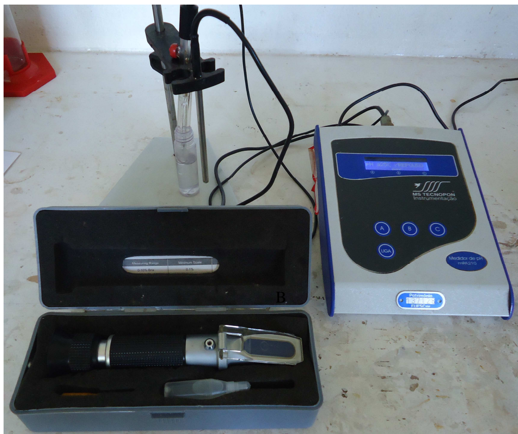
Figura 8 – (A) Refratômetro de campo e (B) Phgâmetro utilizado na quantificação dos parâmetros Brix e pH das amostras.
