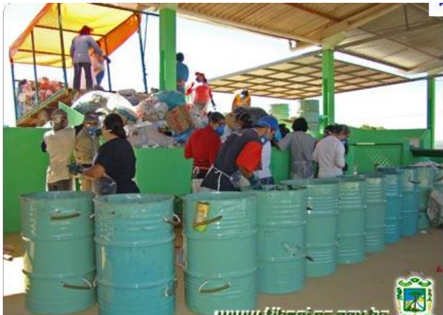
Figura 8 - Uma fase do processo de triagem no CTCT de Tibagi - acondicionamento dos resíduos em tambores
