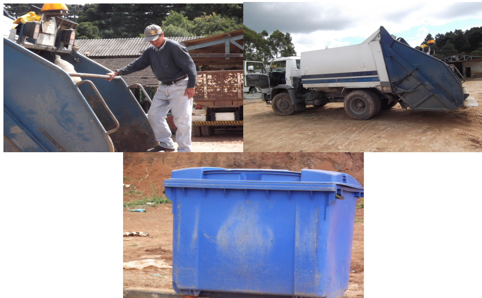
Fotos 1, 2 e 3: caminhão basculante e caçamba para coleta de lixo Fonte: acervo particular da pesquisadora
