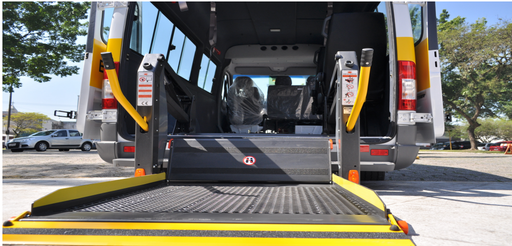
Figura 9 - Van adaptada com elevador elétrico para a entrada de cadeirantes.
