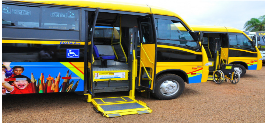
Figura 1 - Microônibus com plataforma elevatória eletro-hidráulico para a entrada de cadeirantes.
