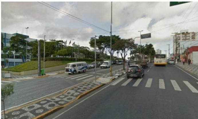
Figura 10 - Guias rebaixadas em via defronte a Prefeitura Municipal, porém com colocação de piso tátil de maneira errada.
