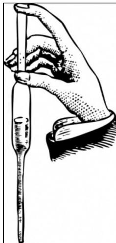
Figura 2 - Demonstração da pressão do ar sobre a água nas pipetas
