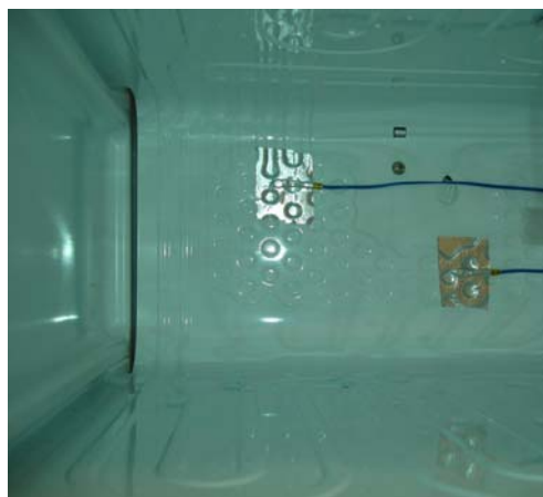
Figura 3.6. Fixação dos termopares na parede do evaporador.
