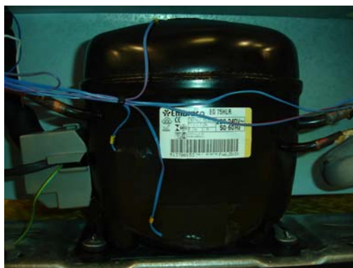
Figura 3.4. Posicionamento dos termopares na carcaça do compressor.
