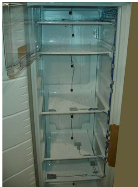
Figura 3.7. Posicionamento dos termopares para medição da temperatura do ar no interior do gabinete refrigerado.
