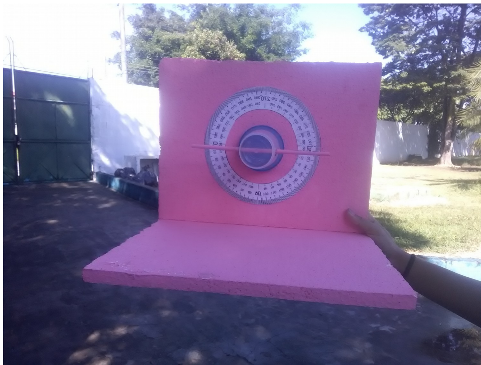
FIGURA 6: Teodolito feito pelos alunos da EE. Major Miguel Naked-Município de São José dos Campos/SP.
