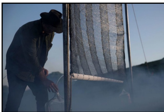
Figura 7 - Coleta do Orvalho com Telas de Malha Raschel
