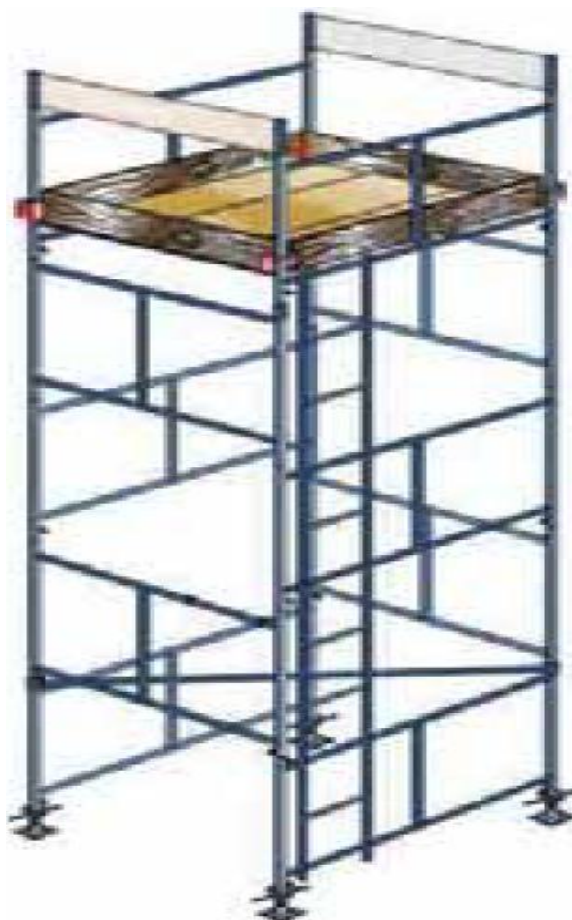
Figura 9 – Andaime Simplesmente Apoiado Fonte: Pampalon, 2002
