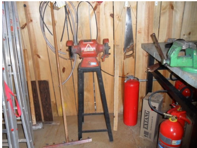
Fotografia 15: rodinho de limpeza, caixa de papelão, extintores. Materiais que podem causar acidente de trabalho quando o trabalhador for utilizar o maquinário da foto (área interna da manutenção).
