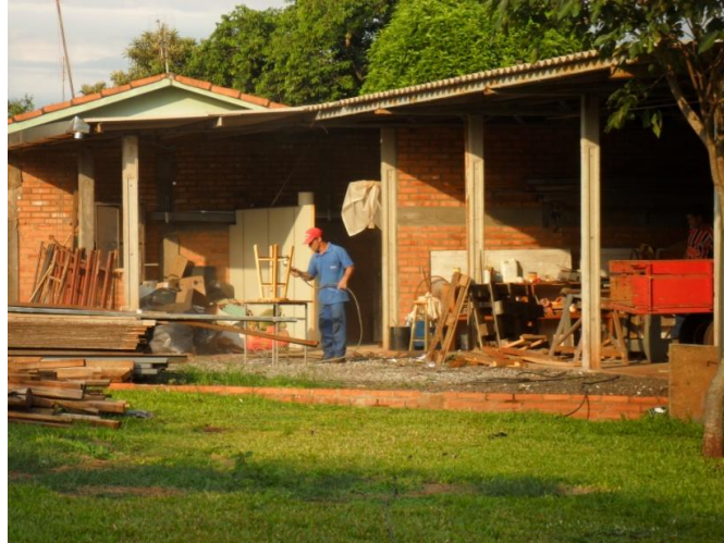
Fotografia 35: trabalhador pintando móvel sem o uso dos EPI's.
