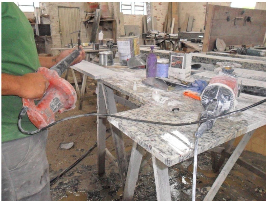
Figura 04: Etapa de acabamento.
