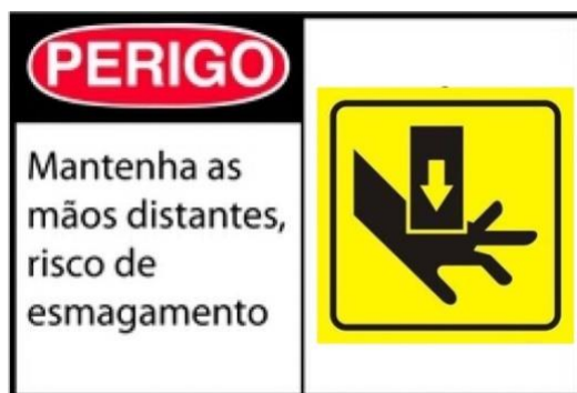
Figura 25 - Aviso risco de esmagamento dos pistões hidráulicos. Fonte: O Autor, 2018.
