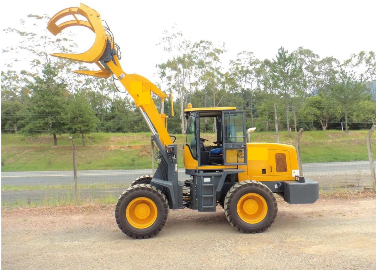
**Figura 1: Trator com concha hidráulica para movimentação de toras.**
