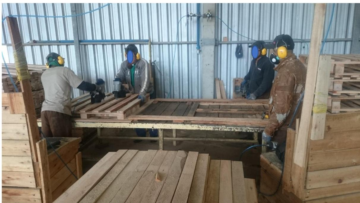
**Figura 7 – Mesa de Montagem – Pregador Pneumático.**
