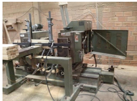
Figura 22 - Respigadeira: Utilizada para realizar encaixes em madeira Fonte: Autoria Própria.
