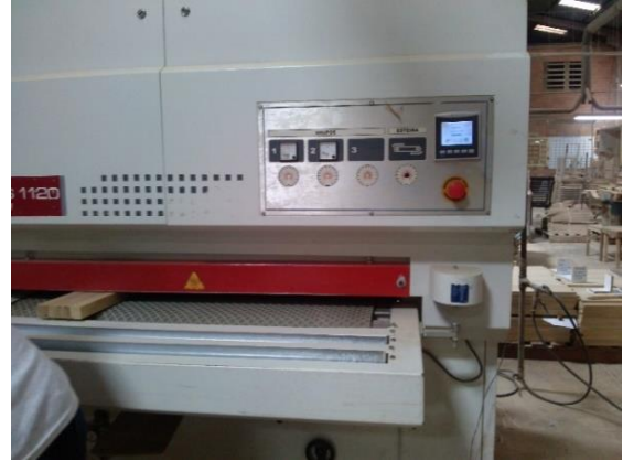
Figura 20 - Lixadeira: Utilizada para realizar desbaste em superfícies Fonte: Autoria Própria.
