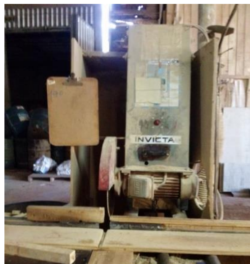
Figura 16 - Utilizada para realizar quaisquer tipos de cortes retos ou irregulares, tais como círculos ou ondulações Fonte: Autoria própria
