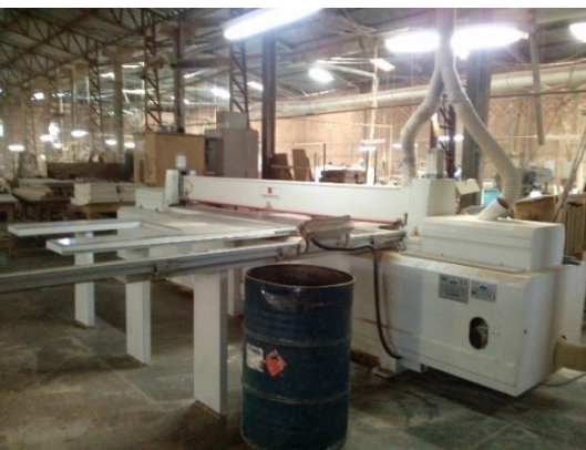
Figura 19 - Seccionadora: Utilizada para realizar cortes em painéis Fonte: Autoria Própria.
