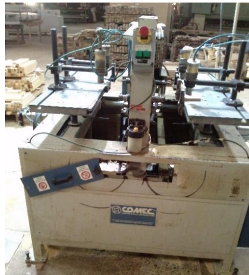
Figura 21 - Furadeira: Utilizada para executar furos em madeira Fonte: Autoria Própria.
