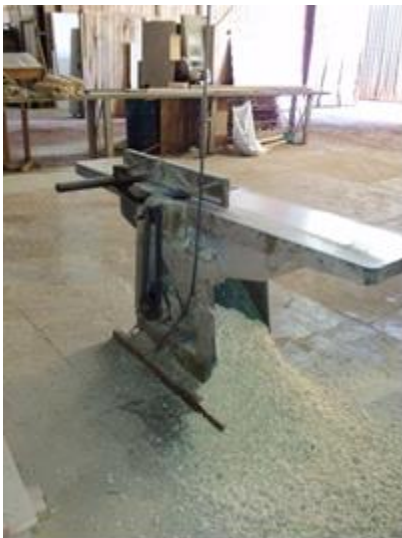
Figura 14 - Desempenadeira: Utilizada para desempenar a madeira, deixando-a mais plana possível Fonte: Autoria própria
