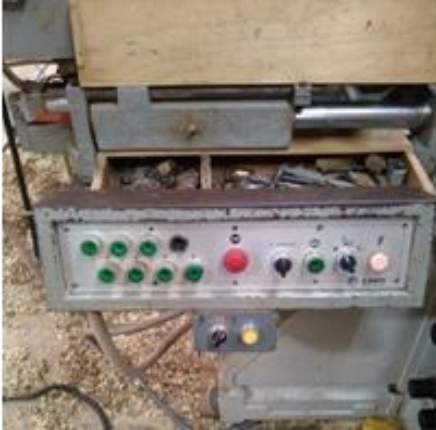
Figura 17 - Copiadora: utilizada para produzir peças curvas Fonte: Autoria Própria.
