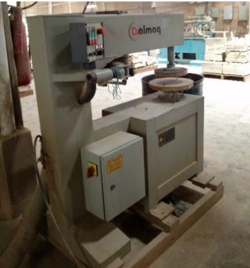
Figura 18 - Copiadora de Assento: Utilizada para desempenar a madeira Fonte: Autoria Própria.
