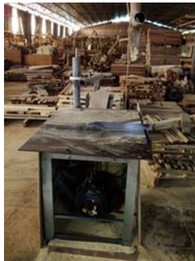
Figura 15 - Serra Circular: Utilizada para fazer cortes longitudinais em tábuas e madeiras em geral Fonte: Autoria própria
