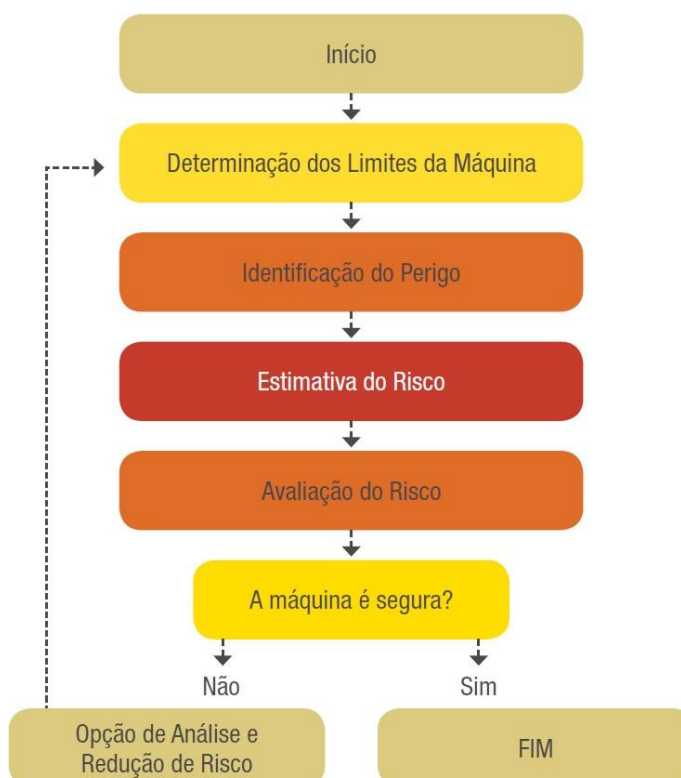
Figura 3 - Representação Esquemática do Processo Apreciação de Risco. Fonte: Projeto de apoio aos diálogos setoriais União Europeia (2015).
