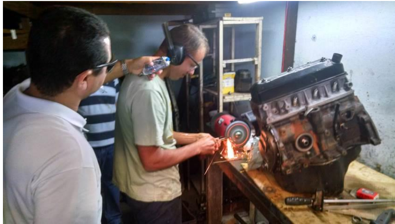
Figura 10 – Medição de ruído esmerilhadeira
