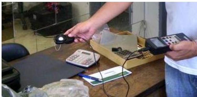
Figura 9 – Medição da lux no escritório
