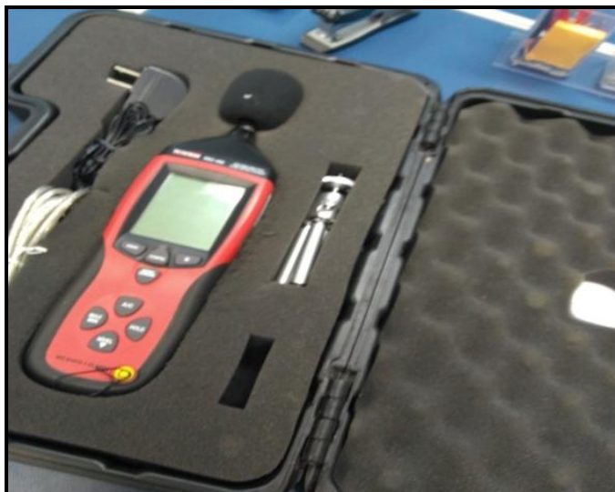
Fotografia 1. Decibelímetro com datalogger da marca Istrutherm DEC-490
