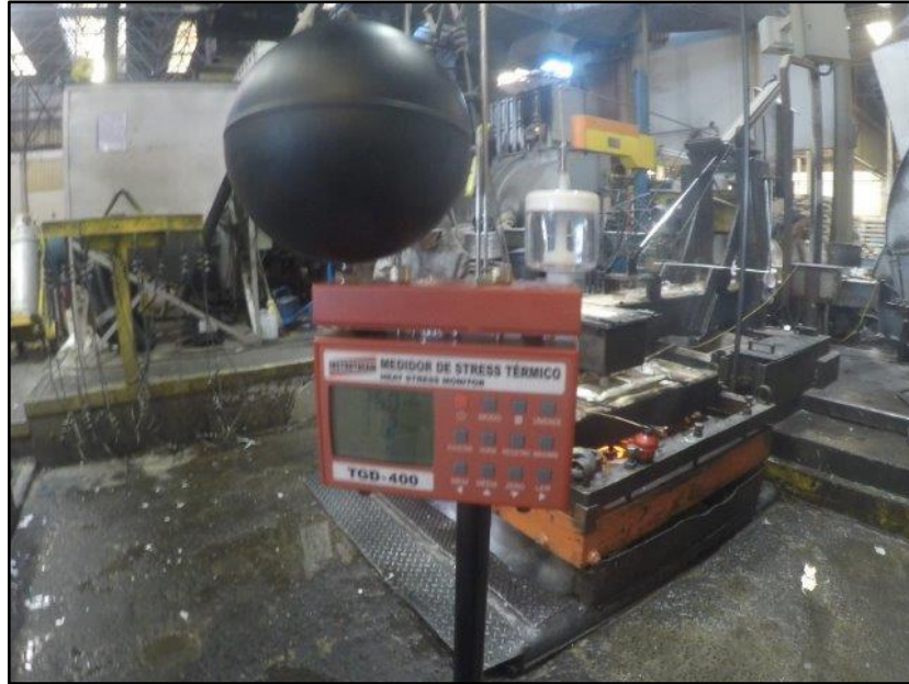
Figura 1. Termômetro de globo e bulbo TGD-400 Fonte: Autoria própria
