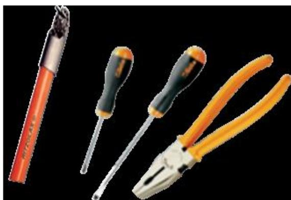
Figura 7 - Ferramentas adequadas para trabalhos com eletricidade.
