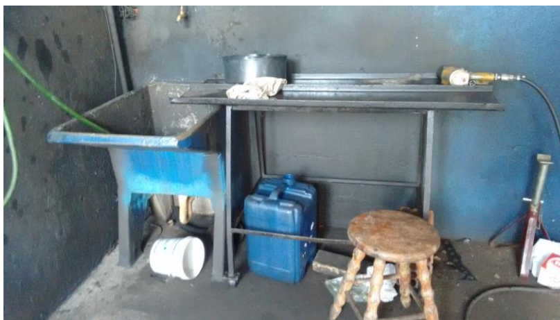
Fotografia 10: Tanque para lavagem de peças
