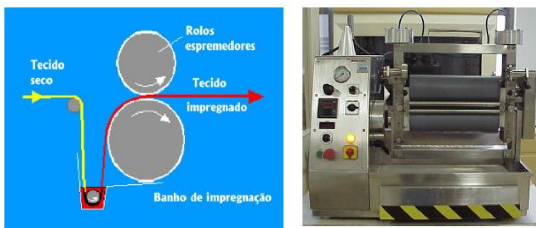
Figura 11 – Foulard: Equipamento de Beneficiamento Têxtil Fonte: Peixoto (2011)
