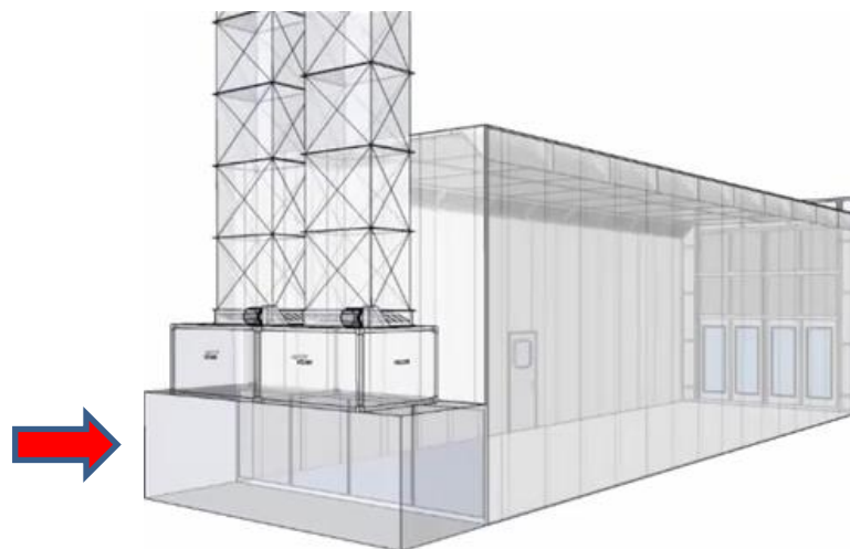
Figura 2 – Sistema de exaustão da cabine de pintura Fonte: Manual de Instruções – DMC
