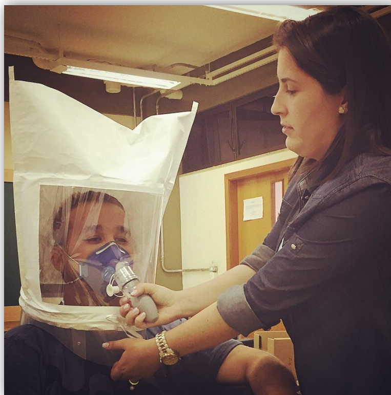
Fotografia 6 – Exemplo de aplicação de teste de vedação Fonte: Autoria Própria
