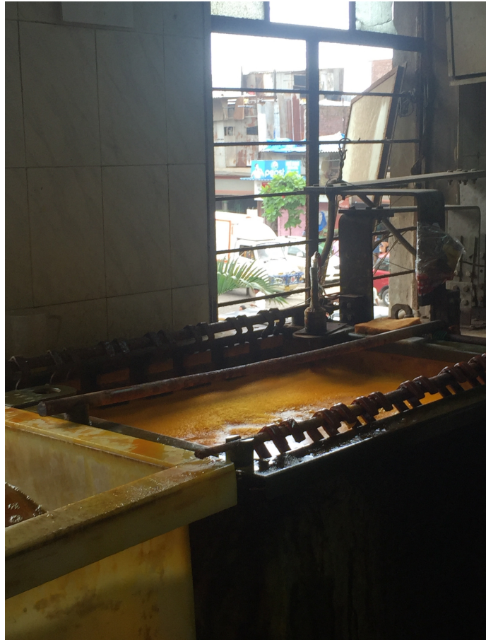
Foto16: Tanque de cromo sem Ventilação Local Exaustora: Foto galvânica na Índia, 2016.
