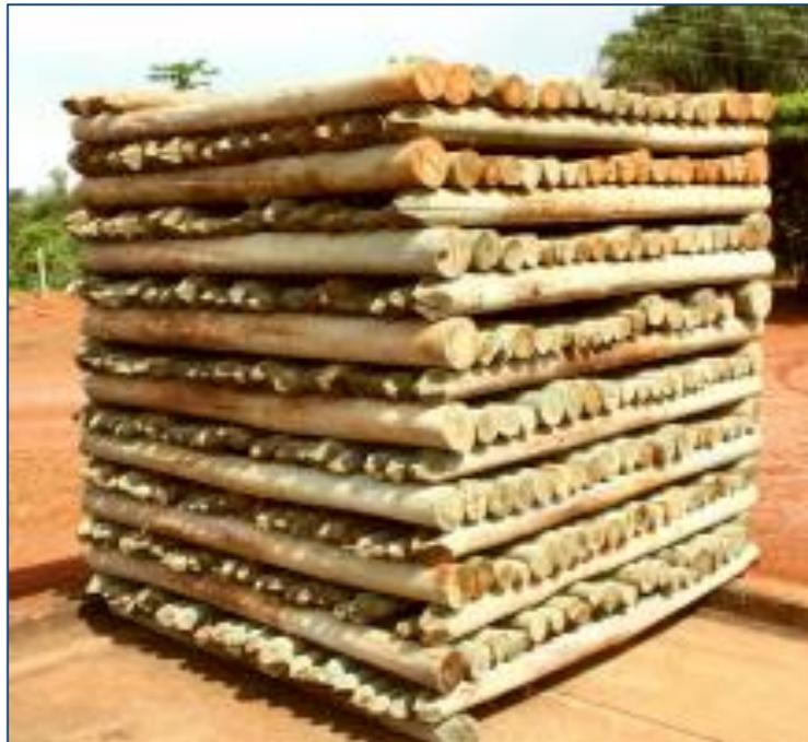
**Figura 4 - Empilhamento correto para o processo de secagem**
