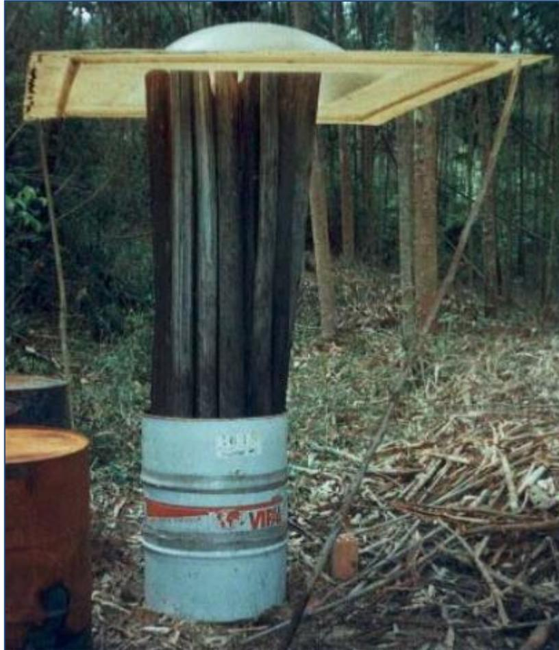
**Figura 1 - Troncos de eucalipto em repouso para a absorção da solução imunizadora**
