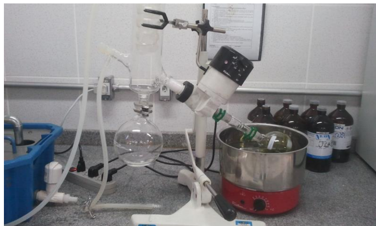
Figura 3 - Concentração dos extratos em Rotaevaporador Rotativo.
