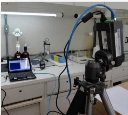
Figura 11: Análise termográfica. (A) Câmera para radiação infravermelha, modelo A325 da FLIR Systems, Inc (USA). (B) Captação de imagem da superfície plantar do camundongo anestesiado.
